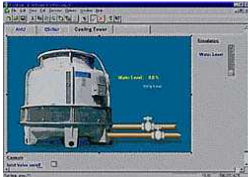
รูปที่ 8 ตัวอย่างโปรแกรมที่ใช้ดูแลCooling Tower พร้อมรายการซ่อมบำรุง
